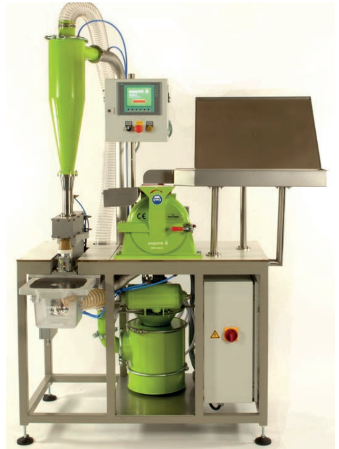
Afb. 6 Een Peppink 200 AN-C slagkruismolen voor 60 monstermalingen per uur, uitgevoerd met automatische tussentijdse reiniging
