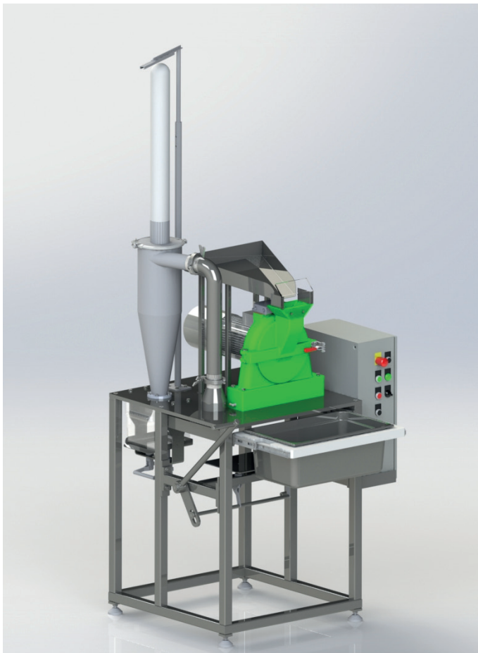
Afb. 5 Tekening van de Peppink 200AN-D voor Cargill in Wormer, voor de verwerking van chocolademonsters. Levering eind april 2018
