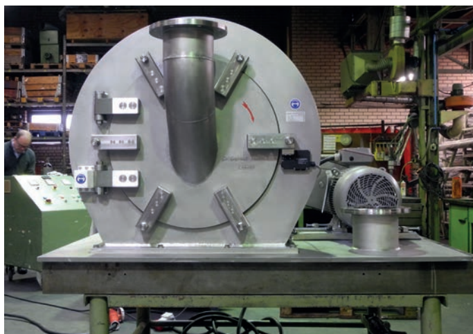
Afb. 3a en 3b De robuuste sluiting van een 600W slagkruismolen
